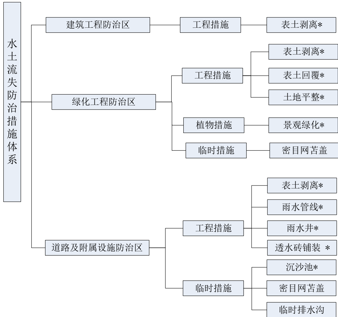
图 5.2-1 水土流失防治措施体系图（*代表主体已列措施）
